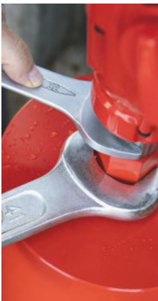
Bohrkrone aufschrauben Ø 150 mm - 3,7 kg
