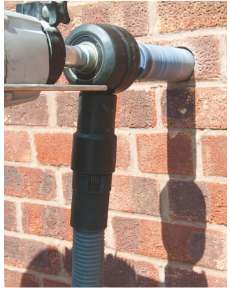
Staubreduziertes Bohren mit der Marcris Staubabsaugung*
