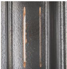
ultradünne Schnittkante im Vergleich mit herkömmlichen Scheiben
