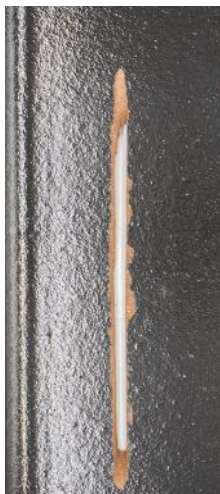
Standard-Schnittbreite bei Ø 230 mm: ca. 3,2 mm
