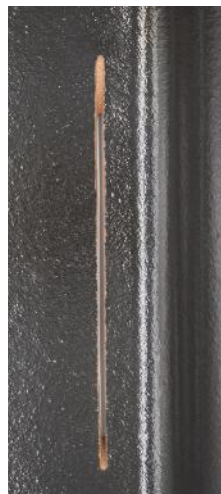
AkkuMAX -Schnittbreite bei Ø 230 mm: ca. 1,76 mm
