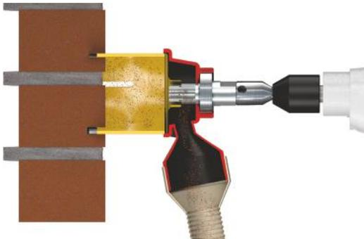
Staubreduziertes Bohren mit der Marcris Staubabsaugung\*
