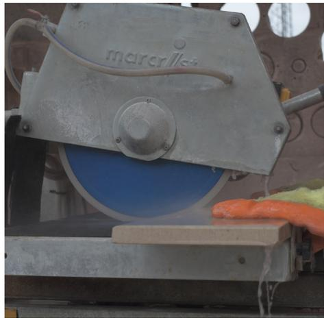
Ab einem Durchmesser von 300 mm und größer ist die Wasserzufuhr notwendig mit Hinblick auf die:
